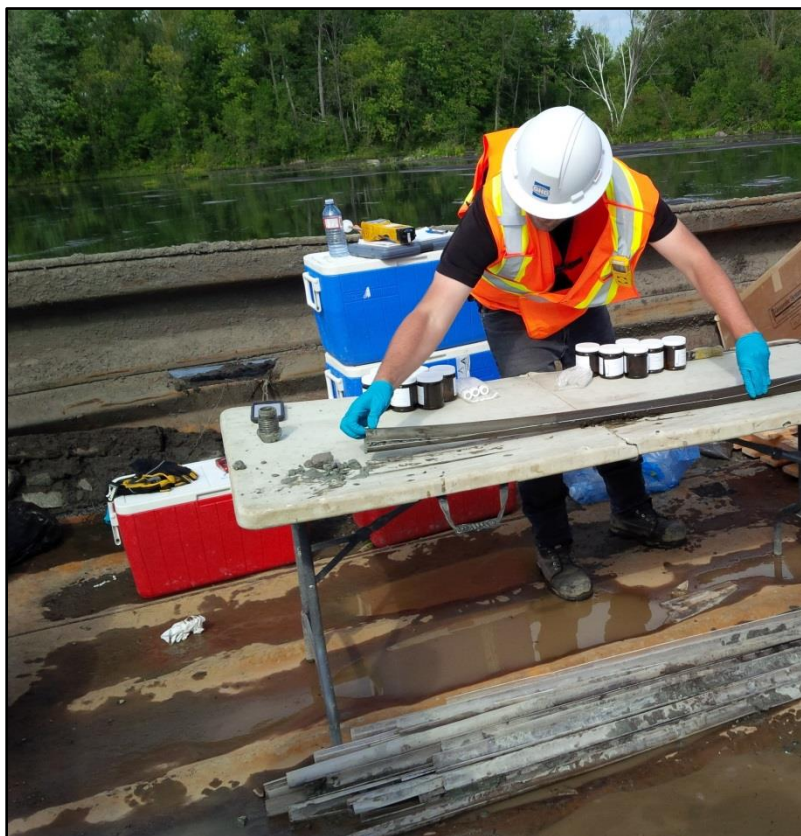
Échantillonnage du fond de l'étang pour en mesurer la contamination
